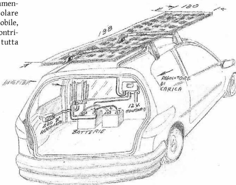
PROGETTO DI UN IMPIANTO SOLARE DA 420 WATT MONTATO SU DI UN'AUTO DI SERIE - I PANNELLI SOLARI FUNZIONANO ANCHE DA PORTAPACCHI BASTA FARE UN SUPPORTO ABBASTANZA ROBUSTO CHE DEVE FUNZIONARE PERÒ ANCHE PER INCLINARE I PANNELLI IN DIREZIONE DEL SOLE QUANDO LA MACCHINA È FERMA.
